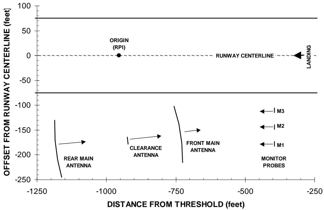
Figure 9-9. Antenna Orientation
